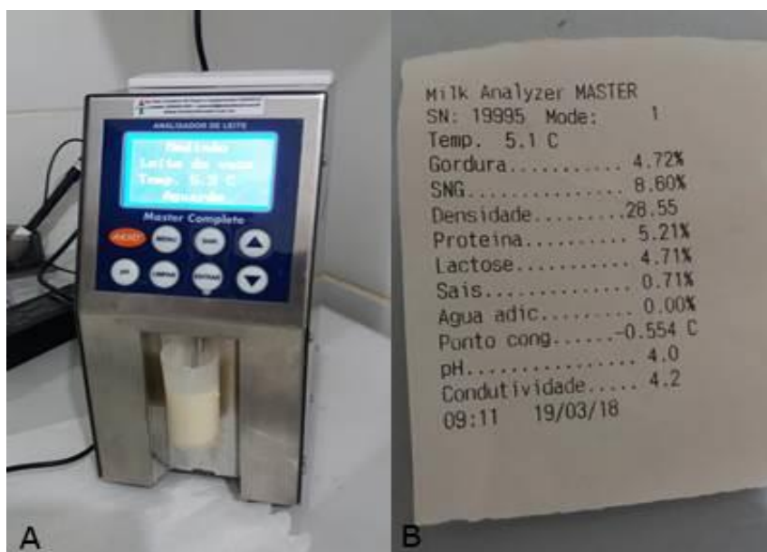
Figura 04: A - Analisador de leite Akso® Master Complete. B – Impressão de resultado de análise. Fonte: Autoria própria.
