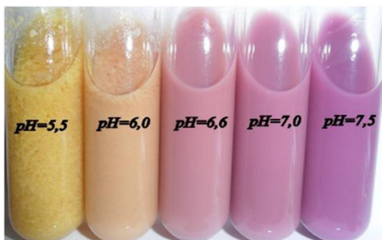
Figura 01. Tubos de ensaio com amostras de leite após o teste do alizarol. Amostras com pH 5,5 e 6,0: leite ácido; amostra com pH 6,6: leite normal; amostra com pH 7,0 e 7,5: leite alcalino Fonte: SANTOS et al., 2011.
